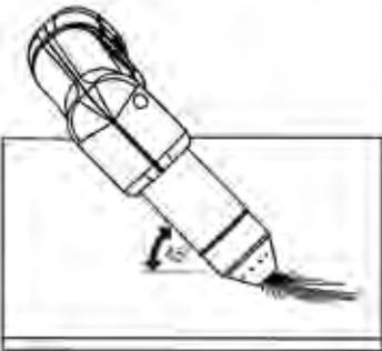
Den Brenner in einem Winkel von 35° - 45° zum Werkstück halten.
