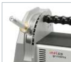
Schleifwinkel von 7,5-90° ermöglichen Spitzwinkel von 15-180°.
