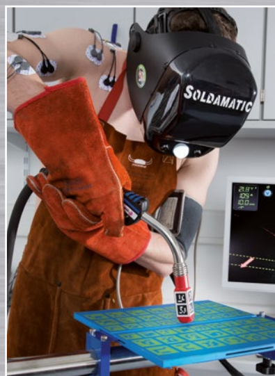
MB EVO PRO 36 in Schweißposition PA (waagrechtes Schweißen von Stumpf- und Kehlnähten).
