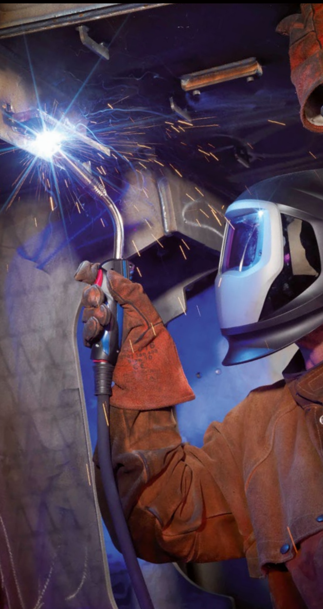
MB EVO PRO 36 in Schweißposition PA (waagrechtes Schweißen von Stumpf- und Kehlnähten).
