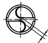
Querschneidenlänge 10% vom Bohrer - Ø
